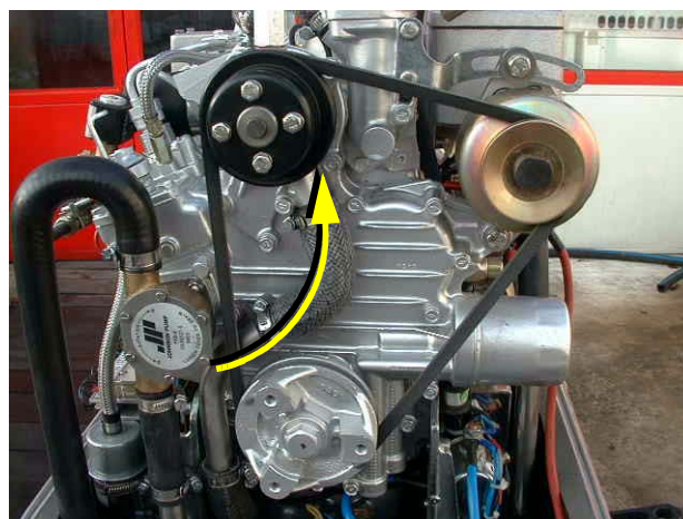
Fig. A.2.3-7: Pompe d'eau du circuit de refroidissement interne
