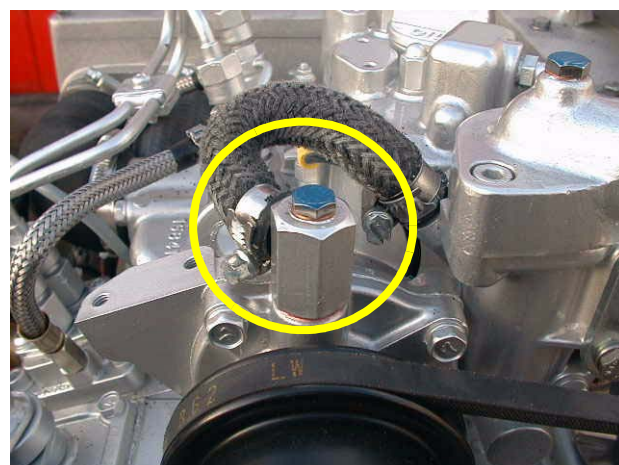
Fig. A.2.3-9: Vis de purge d'air Pompe d'eau de refroidissement
