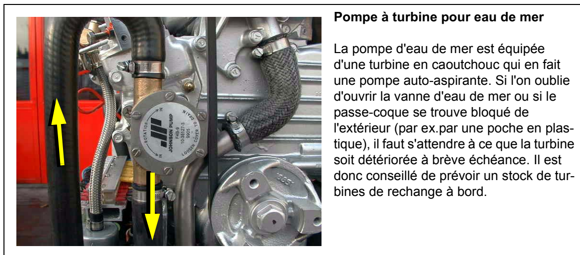
Fig. A.2.2-2: Pompe à turbine pour eau de mer
